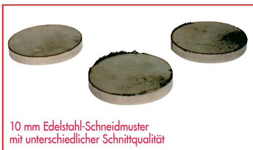
110 mm Edelstahl-Schneidmuster, 5 kW-CO 2 -Laser, zirkularpolarisiert, Phasenverschiebung 90^\circ (\pm 2^\circ)
