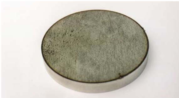
10 mm Edelstahl-Schneidmuster 5 kW-CO 2 -Laser, zirkularpolarisiert, Phasenverschiebung 90^\circ (\pm 2^\circ)
