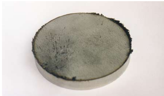
10 mm Edelstahl-Schneidmuster 5 kW-CO 2 -Laser, leicht elliptisch polarisiert, Phasenverschiebung <math><90^\circ</math>
