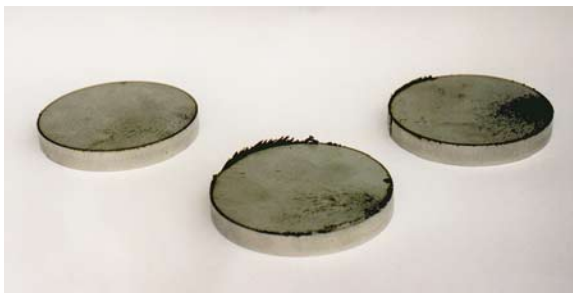
10 mm Edelstahl-Schneidmuster mit unterschiedlicher Schnittqualität
